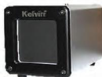
Strumento certificato che, inserito nel campo di ripresa, fornisce un riferimento di temperatura costante e preciso che la telecamera sfrutta per auto-calibrarsi e aumentare l'accuratezza della misurazione.
